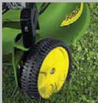
Přední samostatná kola zajišťují u modelu JS63VC vynikající manévrovatelnost v členitém terénu a úzkých zákoutích.
