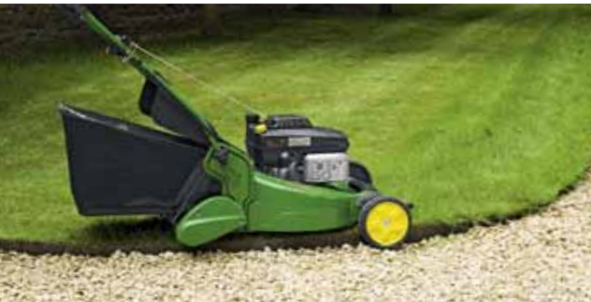
Zadní opěrný válec ochrání vaši trávu před skalpováním okrajů.
