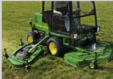
**1515 – výhody předního a bočního žacího ústrojí**
