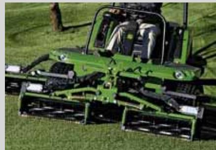
**Extra silná a precizní vřetena (ESP) o průměru 8 palců**
